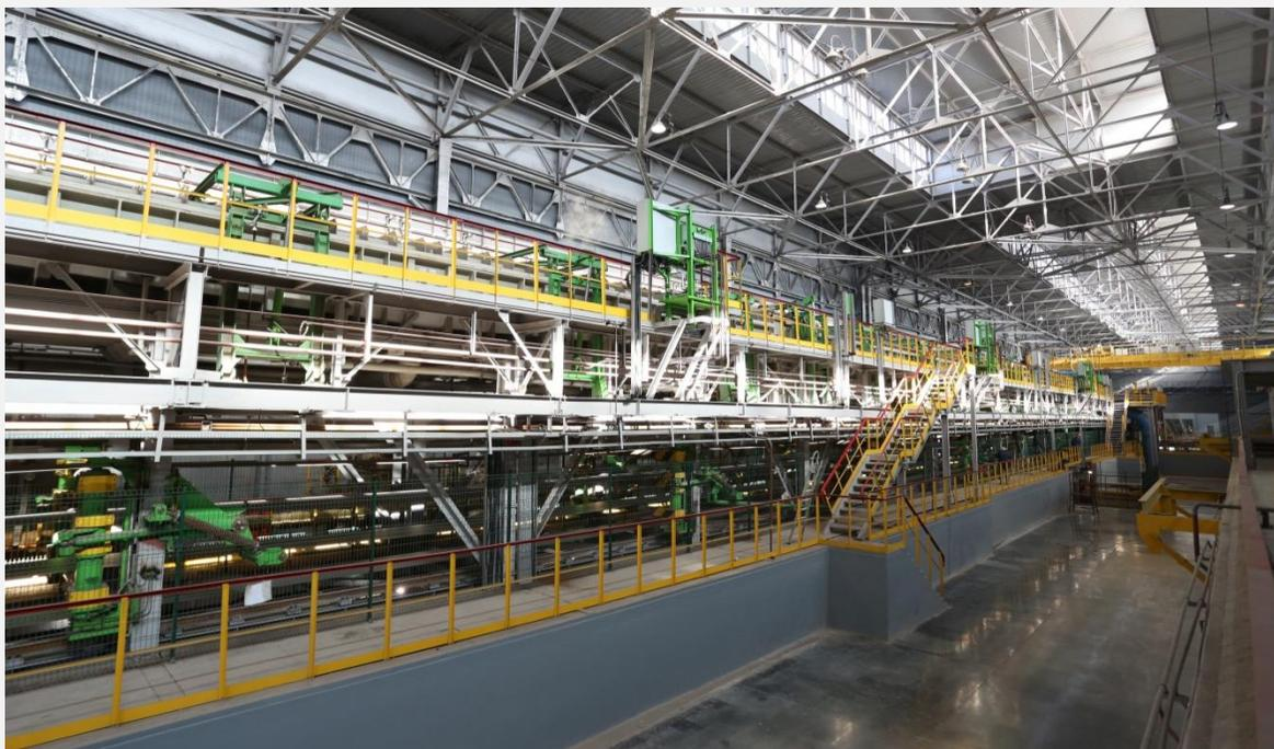
Выполнен полный комплекс СМР по строительству непрерывного травильного агрегата №4 (НТА-4) с установкой регенерации соляной кислоты, установкой обратного осмоса и монтажом стык-сварочной машины.
